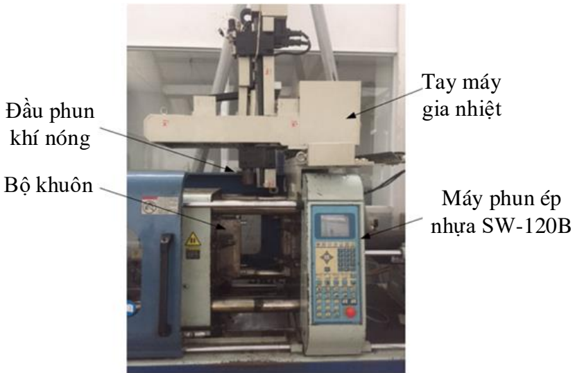
Hình 3.4: Hệ thống thí nghiệm gia nhiệt bằng khí
