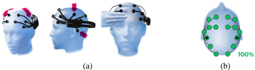
Hình 3.5. Hướng dẫn đeo thiết bị và kiểm tra kết nối: (a) Hướng dẫn đeo thiết bị Emotiv Epoch+; (b) Kiểm tra chất lượng kết nối
