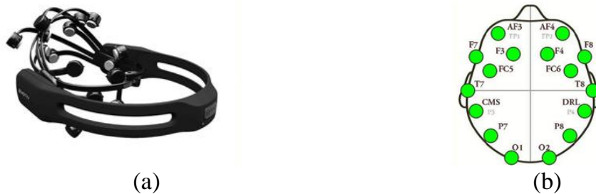
Hình 3.4. Thiết bị Emotiv Epoch+: (a) Mũ Emotiv Epoch+, (b) Vị trí các điện cực
