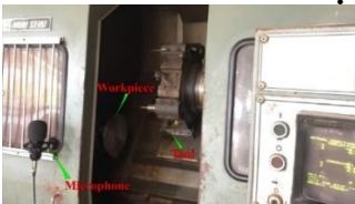
Hình 3.7: Thu thập âm thanh trong quá trình tiện mặt bích
